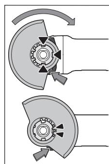
Coloque a tampa de proteção (10) no suporte na ferramenta elétrica, até que os cames de codificação da tampa de proteção coincidam com o suporte. Para tal, pressione e segure a alavanca de desbloqueio (1). Pressione a tampa de proteção (10) sobre a gola do veio até que o reborde da tampa de proteção assente no flange da ferramenta elétrica e rode a tampa de proteção até a mesma
