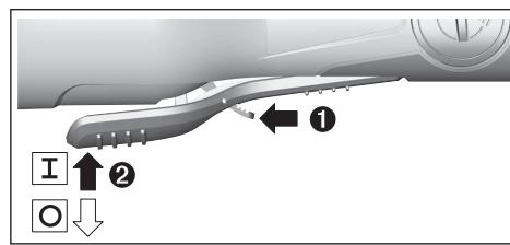
如要运行电动工具，请将解锁杆(9)向前推，然后向上按压起停开关(8)。
