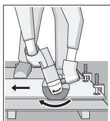
電動工具必須朝機器轉動的相反方向推動。否則可能會因其失控而滑出預先規劃的切線。切割具有凹凸花紋的材料及方管時，最好從橫斷面最小的位置著手。
