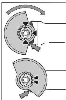
将防护罩(10)放到电动工具的支座上，直至防护罩的编码凸轮与支座重合。按压并按住解锁杆(1)。将防护罩(10)压到主轴颈上，直至防护罩的凸肩套在电动工具的法兰上，然后转动防护罩，直至能够清楚地听见卡止声。根据工作需要调整好防护罩(10)的位置。为此朝上推动解锁杆(1)，然后将防护罩(10)转到所需位置。
