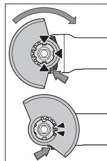
Coloque la cubierta protectora (10) sobre el alojamiento en la herramienta eléctrica, hasta que coincidan las levas de codificación de la cubierta protectora con el alojamiento. Presione y sujeté en ello la palanca de desenclavamiento (1).
