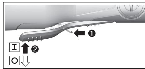
Para la **puesta en servicio** de la herramienta eléctrica, desplace la palanca de desenclavamiento (9) hacia delante y presione luego el interruptor de conexión/desconexión (8) hacia arriba.
