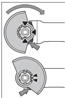
請將防護罩 (10) 放置到電動工具上的支座，防護罩的對位凸件應對準支座。同時按壓解扣桿 (1) 不要放開。將防護罩 (10) 推至軸頸上，使防護罩的凸緣剛好位於電動工具的法蘭上，然後旋轉防護罩，直到清楚聽見卡上的聲音。請依據工作程序的需求，適當調整防護罩 (10) 的位置。其做法是：將解扣桿 (1) 往上推，並將防護罩 (10) 轉至所需位置。
