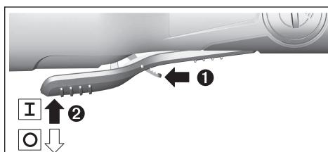
Para a **colocação em funcionamento** da ferramenta elétrica, empurre a alavanca de desbloqueio (9) para a frente e pressione de seguida o interruptor de ligar/desligar (8) para cima.
